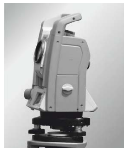
Abb. 3: Große Distanzen und solche, die nur schlecht oder gar nicht mit herkömmlichen Messlaten oder -bändern erreichbar sind, lassen sich mit einem modernen Tachymeter messen.
